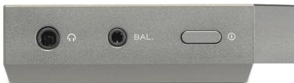
3,5-mm-Klinke für Line und 2,5 mm für symmetrische Endgeräte, rechts wird ein- oder ausgeschaltet
